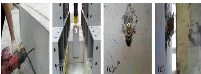
Fig. 3: Shear test (a) & (b) and failure of anchor bolt (c) & (d)
