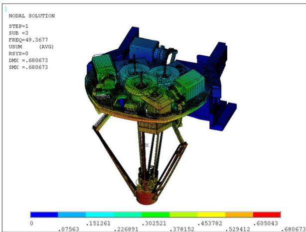
Fig. 15 Mode shape: 3<sup>rd</sup> mode (49Hz)
