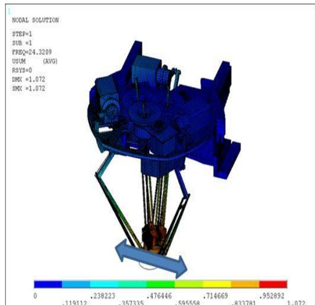
**Fig. 13** Mode shape: 1<sup>st</sup> mode (24Hz)
