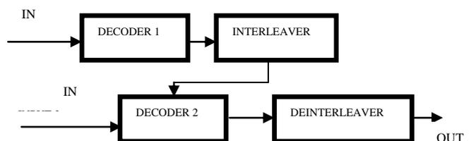
Fig. 5. Turbo decoder
