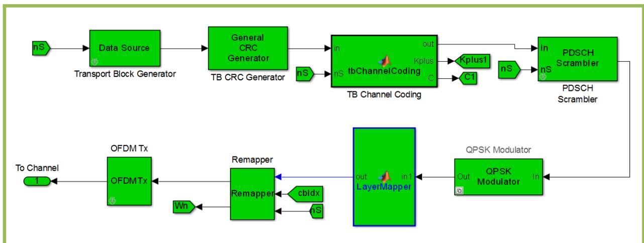
Fig. 4. LTE-Transmission Part
