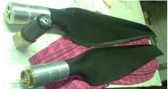
Fig. 6 Final propeller blades
