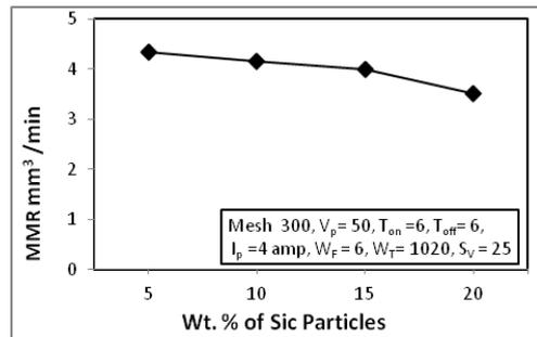
Fig. 12 MMR mm<sup>3</sup>/min Vs Wt. % of Sic Particles
