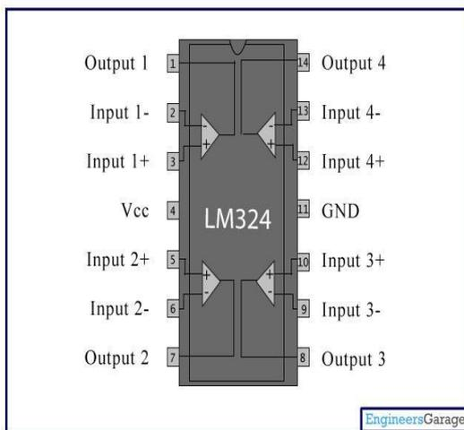
Fig. 5 LM324 Pin Diagram
