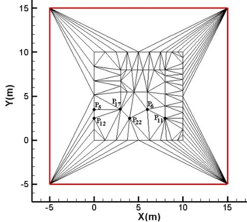
(d) Mesh after inserting boundary nodes
