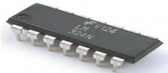
Fig 7: Amplifier IC LM324
