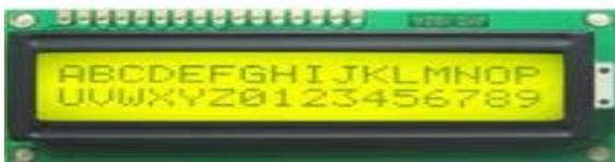
Fig 4 : 16X2 LCD display
